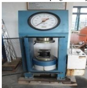
Gambar 2.3 Pengujian kuat tekan beton
