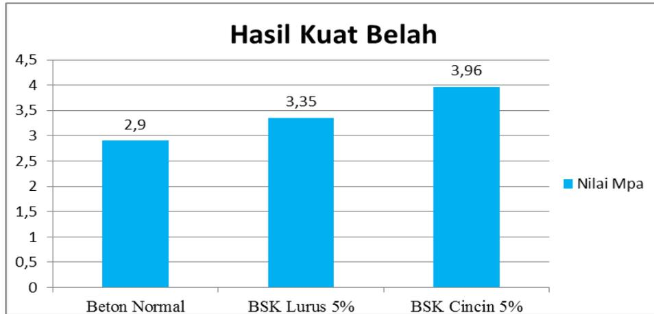
Sama halnya dengan kuat tekan beton, data hasil uji kuat tarik beton normal dengan beton yang menggunakan serat kawat bendrat dengan berbagai variasi menunjukkan bahwa nilai kuat tekan rata-rata benda uji yang menggunakan serat kawat semakin meningkat dari beton normal.
