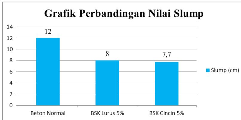
Nilai Slump yang diperoleh dari beton normal jauh lebih besar dibandingkan dengan beton serat kawat cincin dan beton serat lurus. Berdasarkan gambar 4.1 hasil yang didapat yaitu beton normal 12 cm dengan beton serat lurus 8 cm dan beton serat cincin 7,7 cm.
