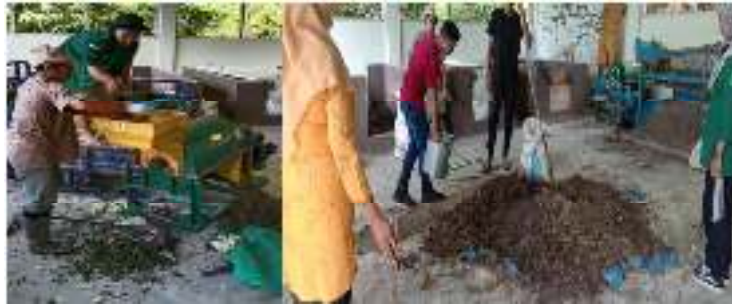
Pencacahan Sampah Organik dengan Mesin Pencacah dan Pembuatan Kompos
