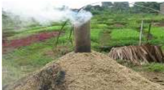
Gambar 3. Prosedur Pembuatan Biochar secara Sederhana dari Sekam Padi
