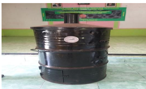
Gambar 1. Alat Pirolisis Drum untuk Pembuatan Biochar
