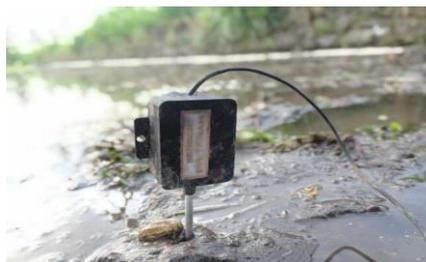
**Gambar 14. Sensor pH Tanah**
