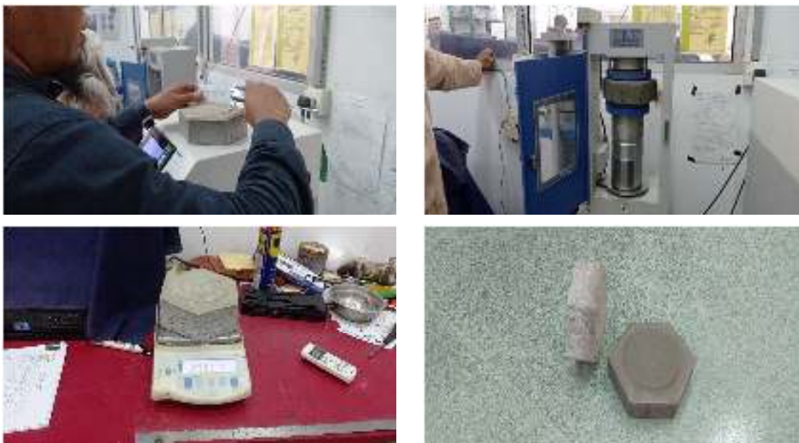
Gambar 3. Pengujian Kuat Tekan Contoh Uji
