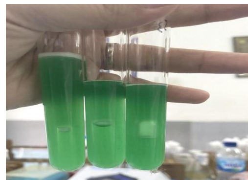
Gambar 2. Gelembung Gas Pada Tabung Durham
