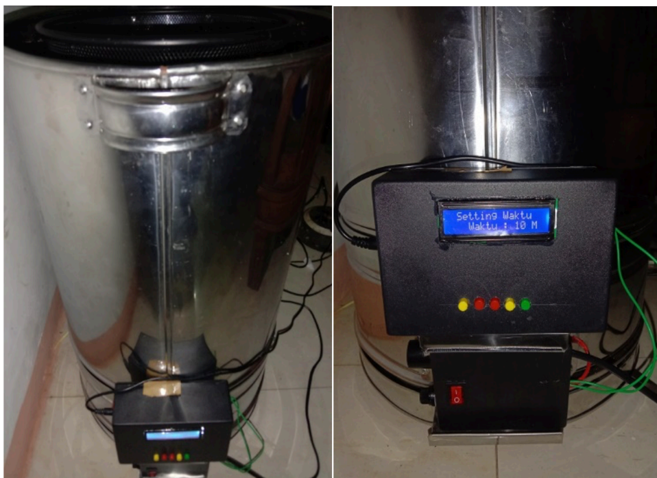
Gambar 5 . Spinner yang terhubung dengan Mikrokontroler
